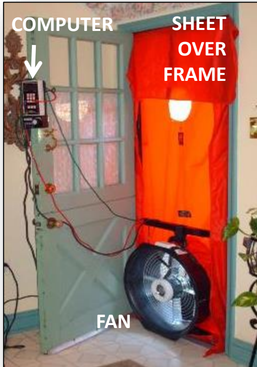
Blower Door set-up
