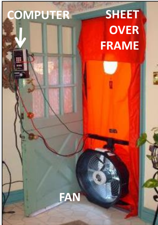
Blower Door set-up
